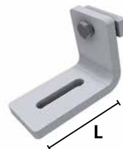
Supporto a L in Inox completo di fissaggio M10x25 (dado 60x17x10 Inox) disponibile con lunghezza 80 e 150 mm
